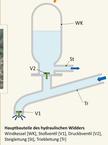
Hauptbauteile des hydraulischen Widders
