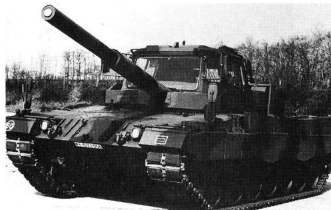
Der Fahrschulpanzer Leopard 2 ist als Sondermodell der Leopardfamilie mit einer Fahrschulkabine ausgestattet. Sie entspricht in Abmessung und Gewicht dem Originalturm
